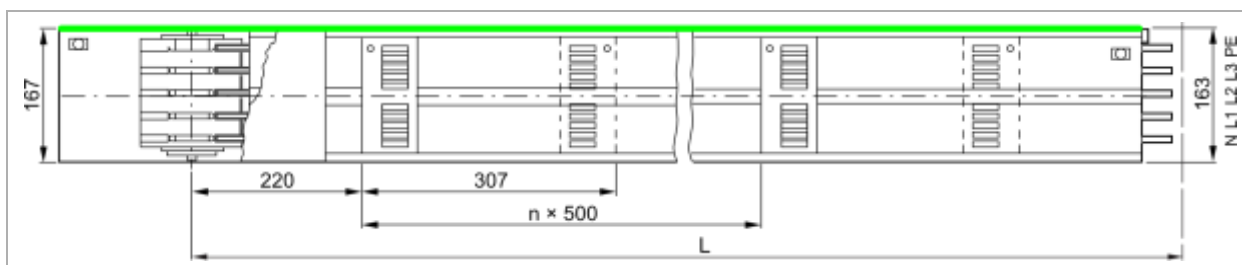
Måttitning på KEM3xS00ZxLMF, förgreningspunktavstånd = 0,5 m
