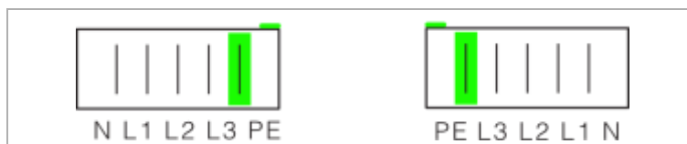
Installationsläge: Kapsling liggande, ledare på högkant
